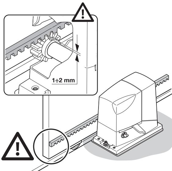
m - вручную сдвиньте створку и, используя шестернию как контрольную точку, закрепите другие элементы зубчатой рейки
