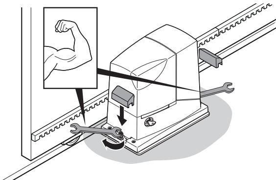
08. Закрепите кронштейны концевых выключателей ОТКРЫТИЯ и ЗАКРЫТИЯ: для обоих кронштейнов концевых выключателей выполняются аналогичные операции
