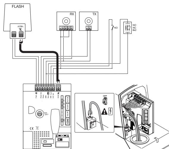
**⚠** Для использования функции «Fototest» необходимо активировать синхронизацию в соответствии с инструкциями по эксплуатации фотодатчиков.
