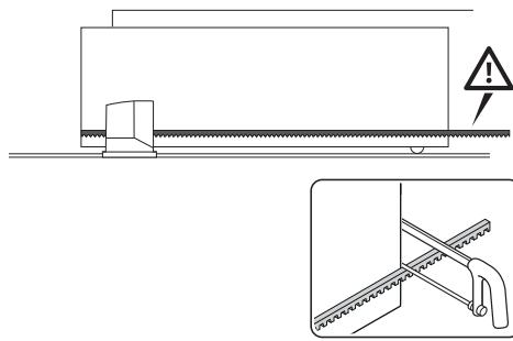
06. Вручную переместите створку в положения открытия и закрытия, чтобы убедиться в параллельном движении зубчатой рейки относительно шестерни.
