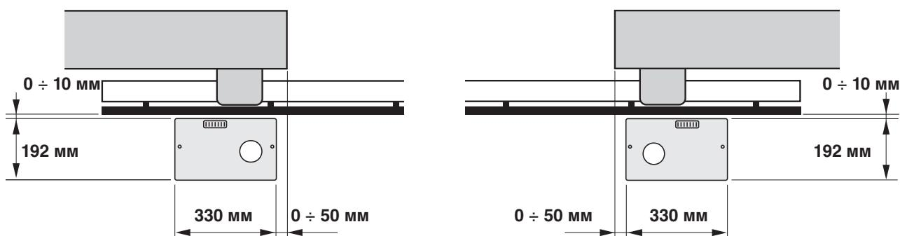
01. Выройте углубление под фундамент и подготовьте трубы для прокладки электрических проводов
