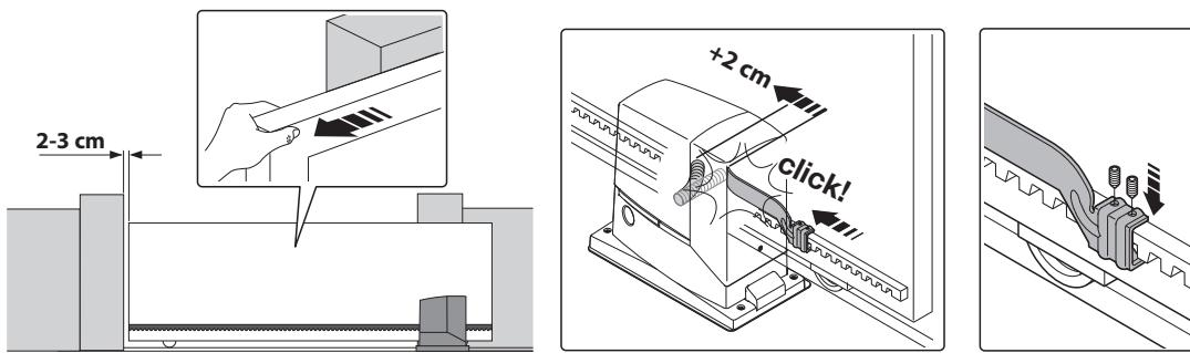
09. Вручную заблокируйте мотор-редуктор
