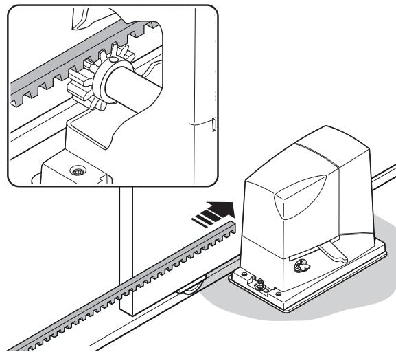
l - прикрепите элемент зубчатой рейки
