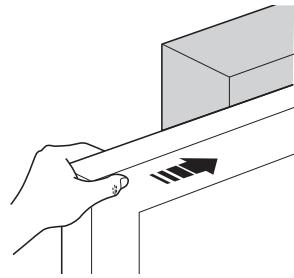
i - установите на шестерню электропривода первый элемент зубчатой рейки: проверьте, чтобы она совпадала с началом створки и чтобы между шестерней и зубчатой рейкой имелся зазор 1÷2 мм (во избежание воздействия веса створки на электропривод)
